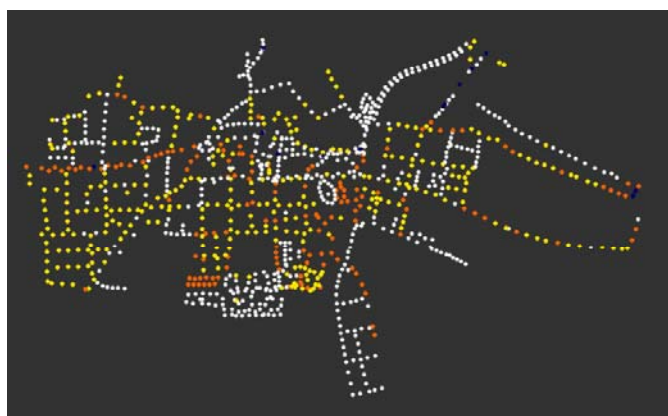
Stav stožárů: ● - dobrý, ● - zhoršený, ● - špatný
